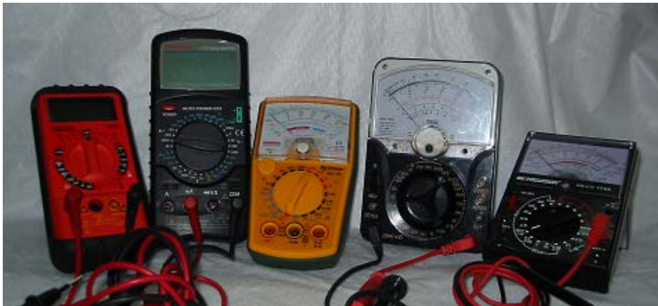
Fig 1. Diferentes tipos de multímetros, los dos primeros de izquierda a derecha son digitales y los restantes son analógicos
